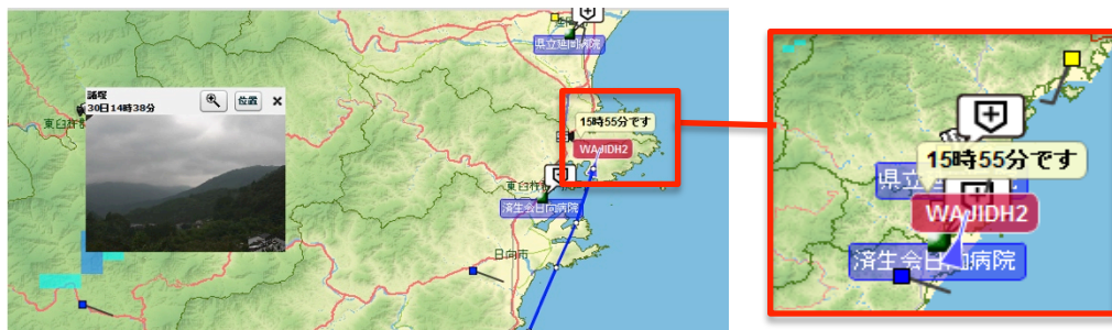
運航判断支援ツール『FOSTER-GA』上に飛行中の機体からのメッセージ表示可能 (平成26年内閣府広域医療搬送訓練当日の様子)
