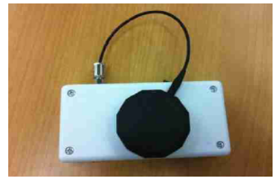
『FOSTER-copilot』実物 大きさ：65x26x130 mm 重さ：202g
