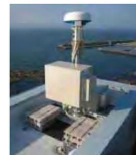
TSUNAMIレーダーを利用した津波対策
