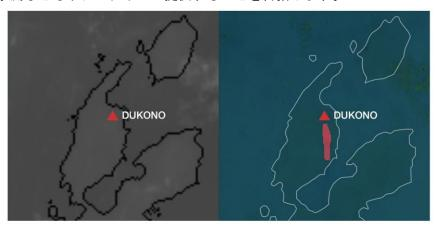
2021 年 4 月 5 日 6:10(JST)のひまわり 8 号赤外画像から、インドネシアハルマヘラ島北部にある DUKONO 火山の噴煙を捉えた様子。 赤外画像では噴煙を確認できない(左)。「AI 火山灰検知システム」により噴煙を捉えた様子(右)。 航空路火山灰情報センターVAAC Darwin による情報からも、噴煙の噴出があることが通知されていた。
