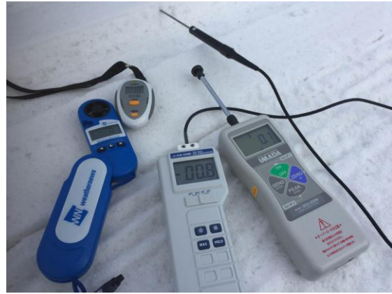
レース会場の風向・風速や雪質の観測に用いる観測機器
