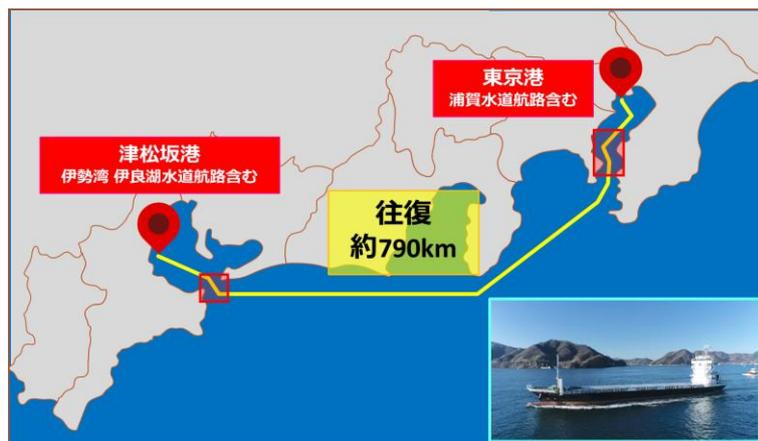
ウェザーニューズは、運航実績データや本船性能データを学習したAIモデルを活用して最適な航路を自動選定する航海計画策定システムの開発、超高解像度予測モデルと確率予測技術の開発、ならびに陸上支援センターでの運航支援を担いました。これらは将来的にウェザーニューズの無人運航船支援サービスのコアテクノロジーに応用されます。
