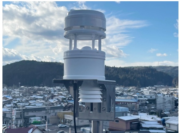
石川県の病院に設置された気象観測機
