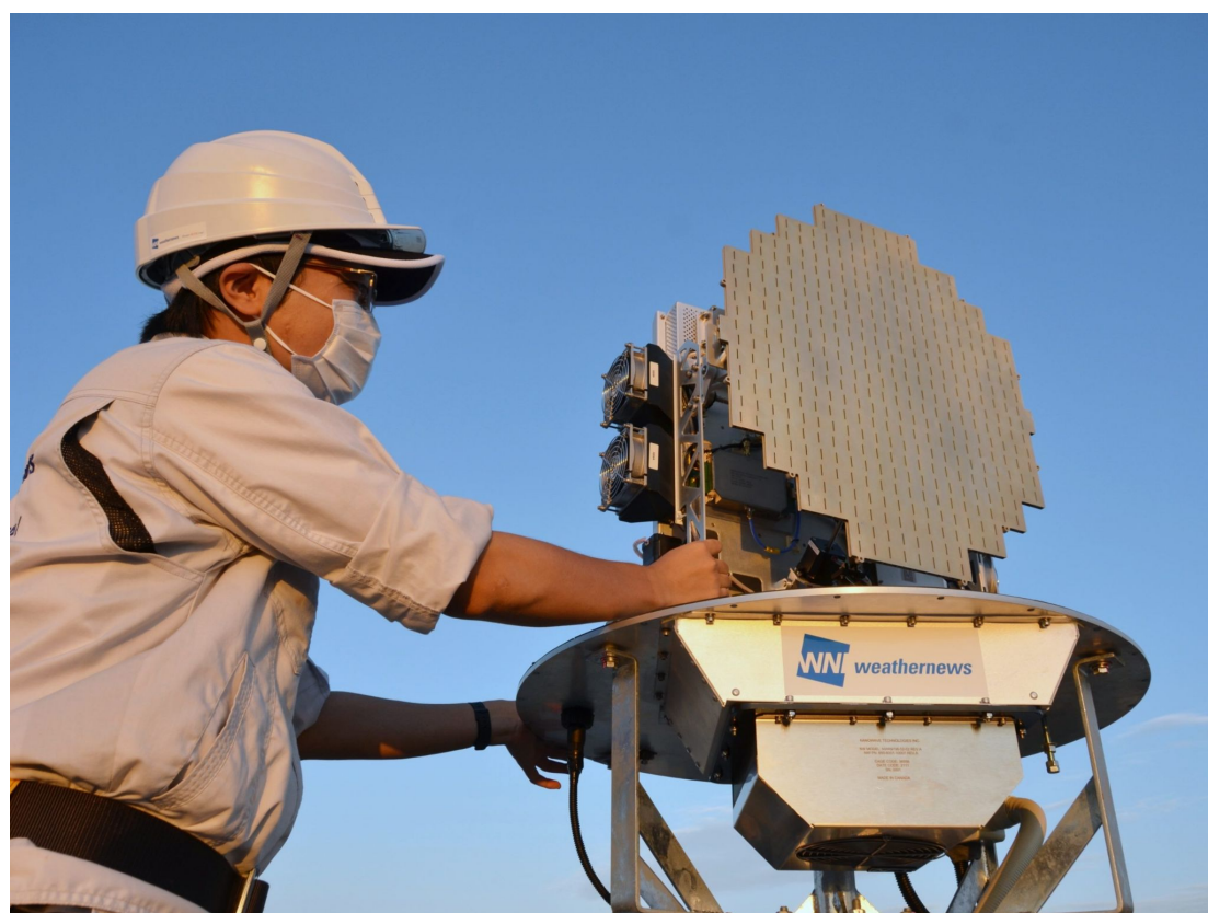
高頻度観測小型気象レーダー「EAGLEレーダー」
