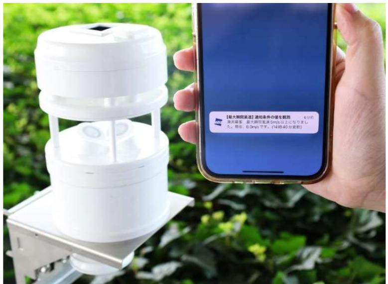
「ソラテナ Pro」と最大瞬間風速のアラート通知
